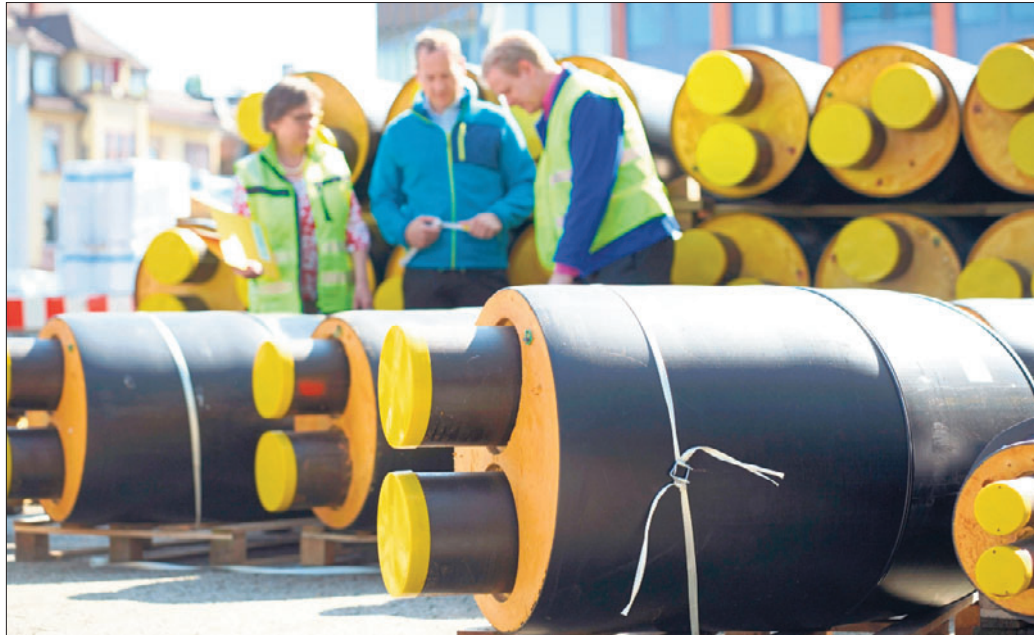
Abwärme ist eine mögliche Wärmequelle für Wärmenetze – hier Wärmenetzrohre.
